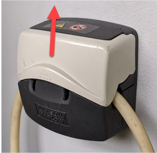
Sluit deksel microdoseersysteem.
