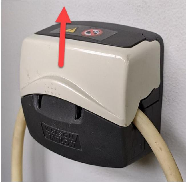
Sluit deksel microdoseersysteem.
